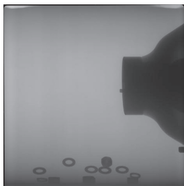
图8 管电压 150 \text{ kV} , 管电流 3 \text{ mA} , 焦距 1.5 \text{ m} , 曝光时间 40 \text{ s} 下遗落零件缺陷结果
